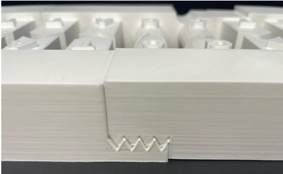
Abb. 12: Verbindung des Zucker-Phosphat-Rückgrats durch Zacken
